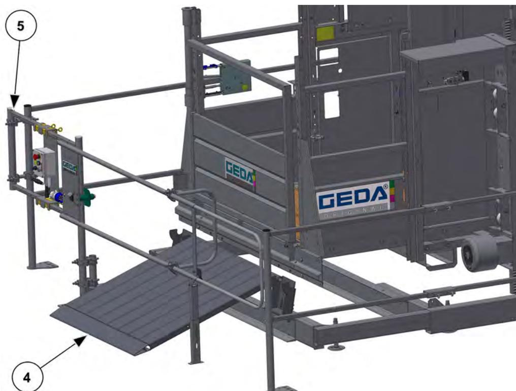
Abb. 50: Auffahrrampe am Bühnenzugang Bodenstation
