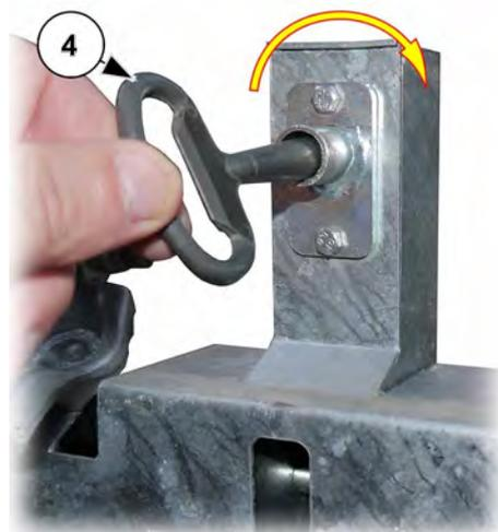
Abb. 74: Notentriegelung der Etagesicherungstür
