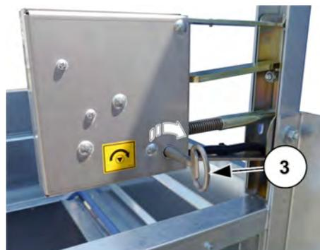
Abb. 49: Notentriegelung Rampe / Beladetür innen
