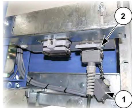
Abb. 102: Blindstecker Fangprobensteuerung
